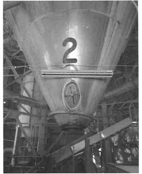
熱風で泥を乾かす乾燥機
